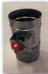
Figura 13. Detalle del dispositivo desarrollado por el grupo de investigación de la UMA para el control del caudal de aire en el pulverizador IRIS de Ilemo Hardi, S.A.U.
