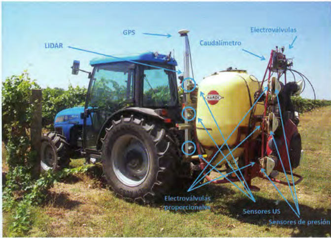
Figura 4. Detalle de los componentes electrónicos empleados para el desarrollo del prototipo de aplicación variable en viña.
