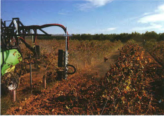
Figura 10. Equipo de pulverización electrostática de Pulverizadores Fede, S.A. utilizado durante las pruebas.
