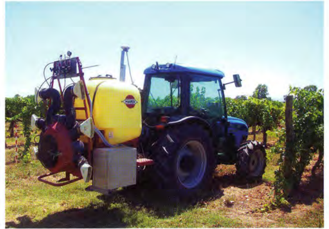
Figura 5. El prototipo de aplicación variable montado sobre un equipo convencional cedido por Ilemo Hardi, S.A.U. Tractor Landini empleado durante los proyectos de investigación cedido por AgriArgo Ibérica.
