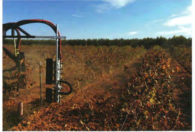
Figura 10. Equipo de pulverización electrostática de Pulverizadores Fede, S.A. utilizado durante las pruebas.
